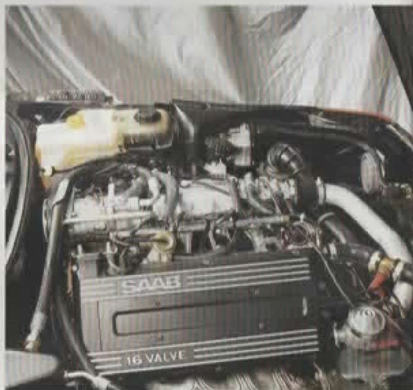
Arriba el poderoso motor de seis cilindros y 24 válvulas del Mercedes SL, y frente a él, la técnica de cuatro válvulas por cilindro y turbo empleada en el Saab 900.
